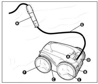
A: Riegel der Filterzugangsklappe
